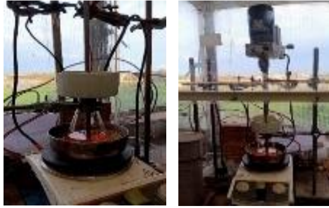
รูปที่ 6 แสดงการตั้งปฏิกิริยาแบบกะ (Batch Reaction)
