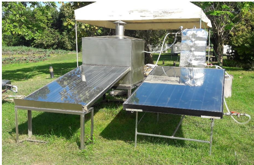
รูปที่ 1 เครื่องอบแห้งพลังงานแสงอาทิตย์ร่วมกับระบบสะสมความร้อน
