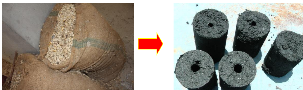
ภาพที่ 6 การเปลี่ยนเชื้อเพลิงจากซังข้าวโพดเป็นถ่านซังข้าวโพด
