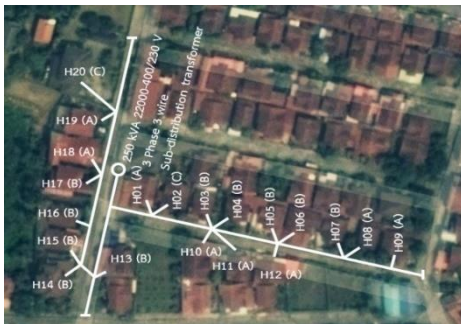
รูปที่ 2 ระบบจำหน่ายแรงดันต่ำที่เชื่อมต่อกับหมู่บ้านหรรษนันท์ 7
