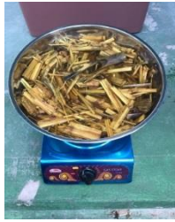
รูปภาพที่ 3 การต้มขานอ้อย - การล้างเชื้อ
